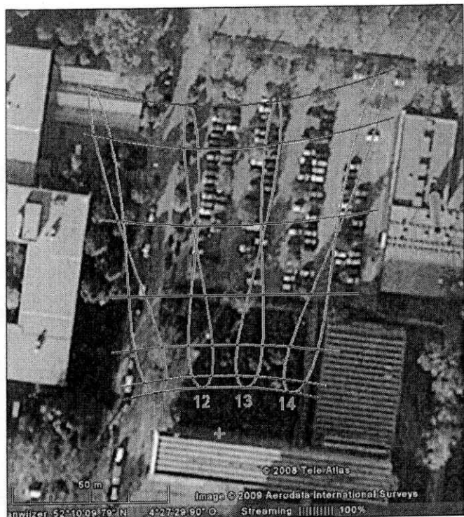
Fig. 6. Verbeterd lijnenpatroon. Het voetpunt van de gnomon is niet op het dak van het Oortgebouw gelegd, maar op de begane grond eronder. Datumlijnen per dierenriem maand.
